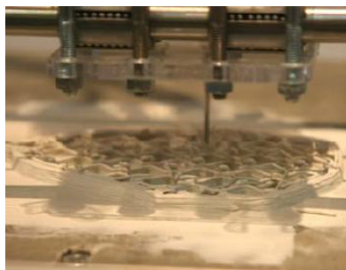
图 2.2 三维打印头打印细节
